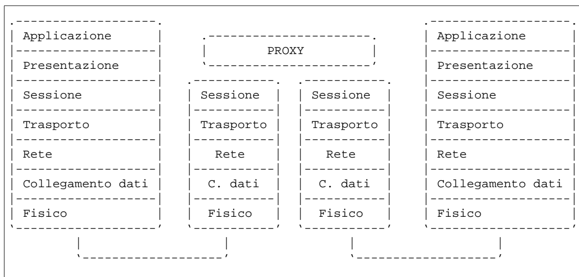
Figura 414.1. Il proxy trasferisce PDU di quinto livello; in pratica gestisce direttamente i protocolli a livello di sessione.
