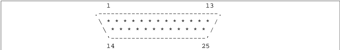
Figura 450.1. Disposizione dei contatti di un connettore BD-25 maschio.
